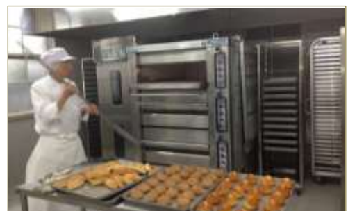
75㎡に幅1.3mの大型オーブンを設置。8時間で約3000個のパンの生産が可能
